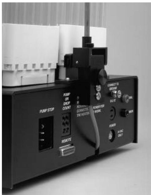
**Figure 2-1. Rack Sensor Position**
