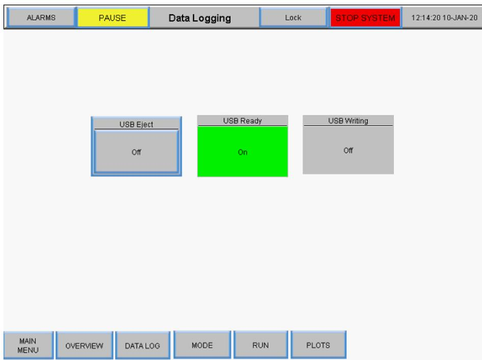
Um Prozessdaten aufzuzeichnen, schließen Sie ein USB-Laufwerk an den USB-Anschluss des Reglers an. Die Datenaufzeichnung wird automatisch aktiviert, wenn ein USB-Laufwerk erkannt wird.
